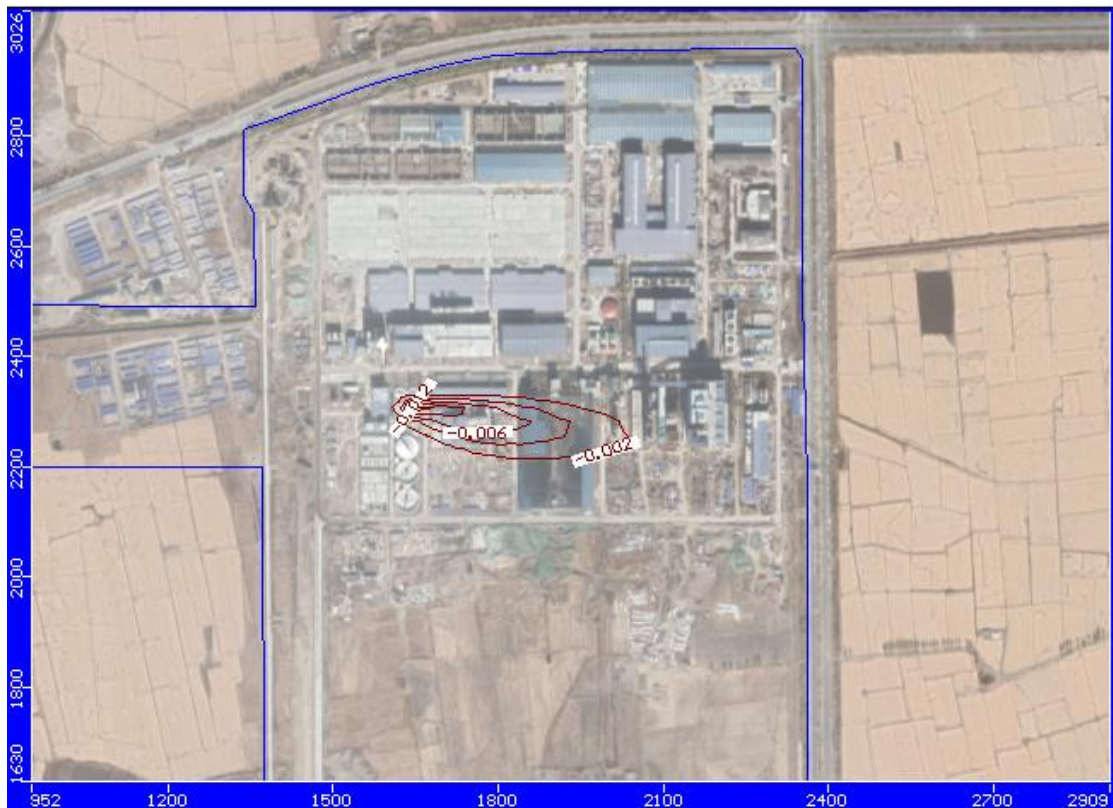
图 5.5-8 非正常工况下污水处理站污染物耗氧量 3650d (10a) 扩散图
